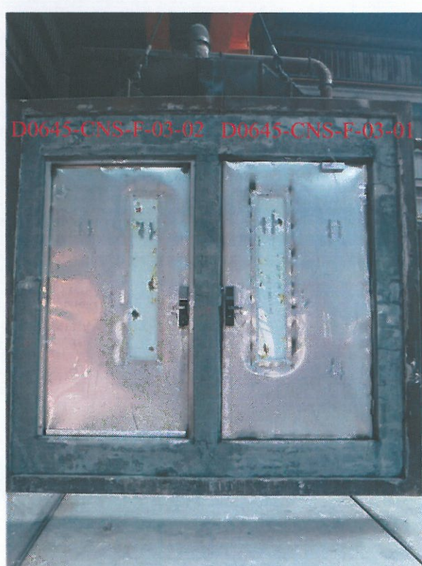
照片 4 加熱後試體非加熱面
