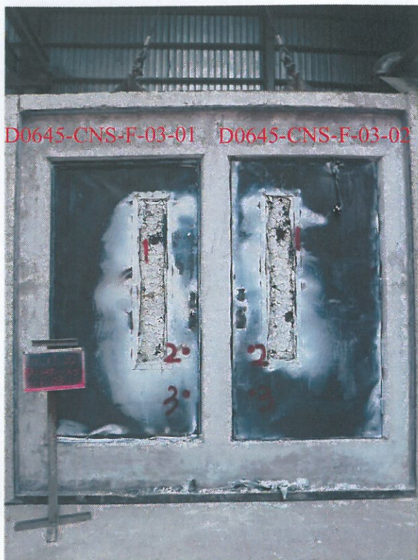
照片 5 衝擊後試體加熱面
