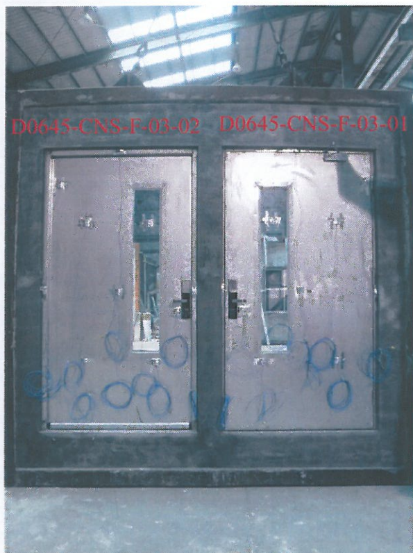
照片 2 加熱前試體非加熱面
