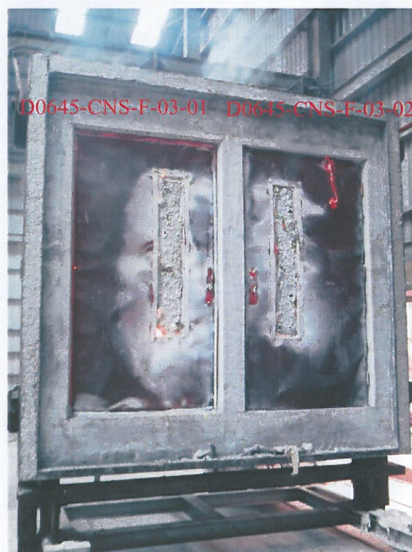
照片 3 加熱後試體加熱面
